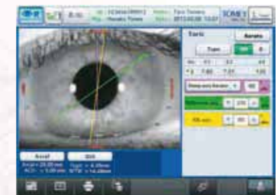
Visualizzazione funzione ausiliaria per Lenti Intraoculari Toriche
